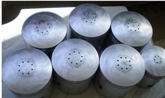
Dieser neue und patentierte Öko-Kolben ist mit einer zwangsgesteuerten Spezial-Einspritzdüse bestückt. Diese Düse hat die Funktion, das Gemisch in einen nahezu homogenen Gaszustand zu überführen. Dadurch ergibt sich ein verbesserter Wirkungsgrad, d.h. die Verbrennung ist wesentlich sauberer und der Motor hat entscheidend weniger schädliche Emissionen. Ansprechverhalten, Leistung und Drehmoment werden ebenso verbessert.
